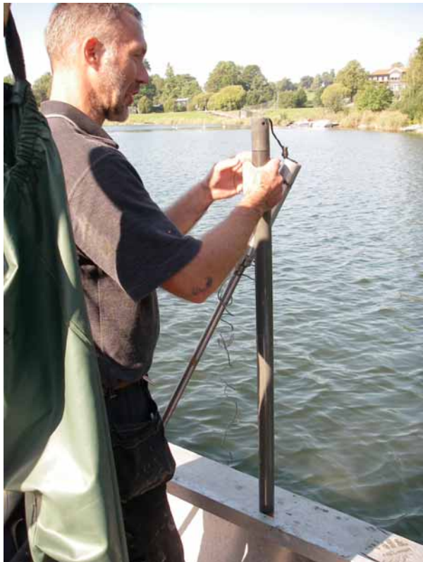
Bild 5. Provtagning av sediment med Livingstonehämtare vid lokalen Inre Mörbyviken i Edsviken, september 2006.
