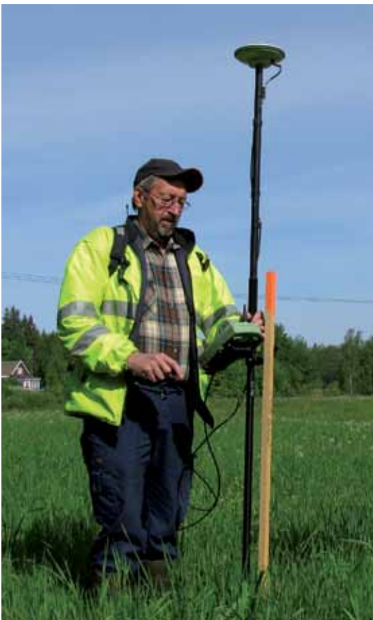
Ledningens sträckning mäts in med hjälp av GPS-utrustning.
