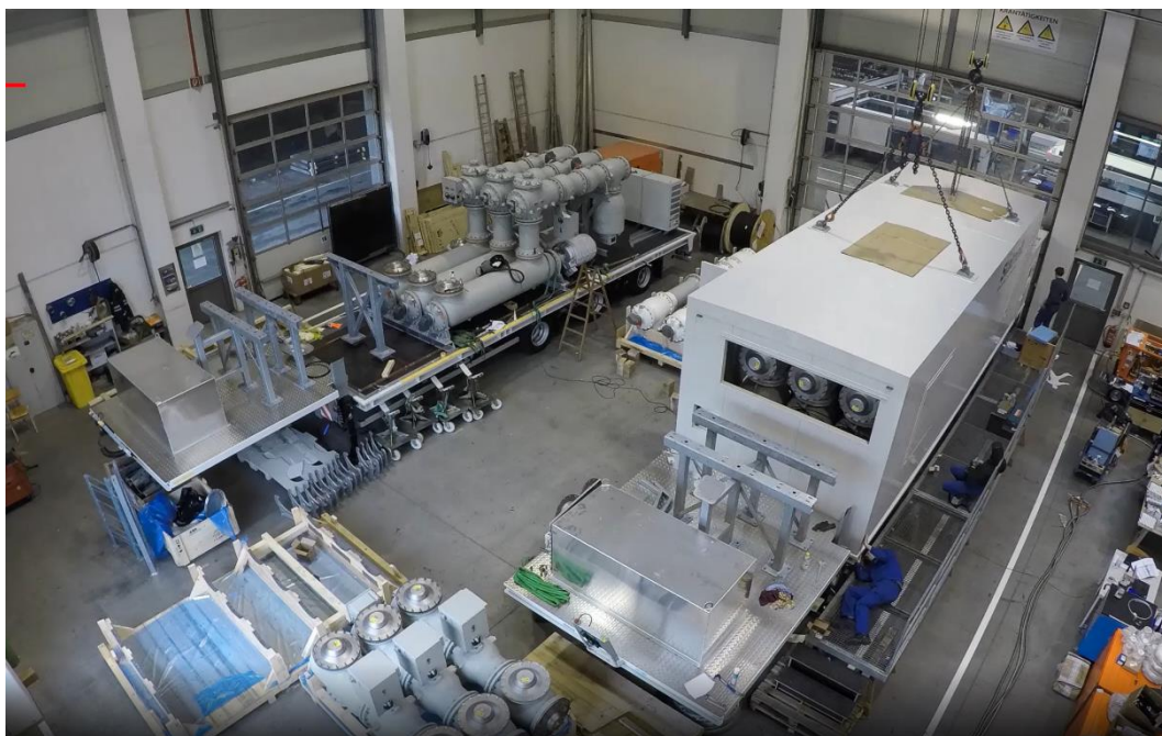
Figur 17: Statnetts två mobila GIS-fack under konstruktion. Trailern till höger i bild har precis fått sin täckkåpa monterad över GIS-utrustningen. På trailrarnas närmaste kortsida syns de tvärgående stöttorna som genomföringarna senare kommer att vila på. Källa: [47]
