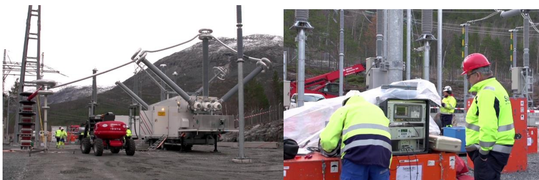
Figur 24: Uppställningen under högspänningstestet utfört av ABB. Källa: [47]
