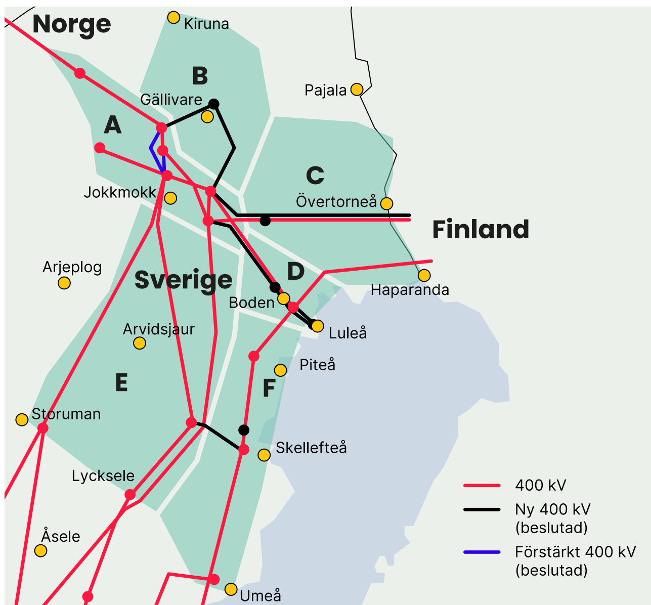
Figur 1. Bilden visar delåtgärdsområden A-F för utveckling av elnätet i Norrbottens län och norra Västerbottens län.
