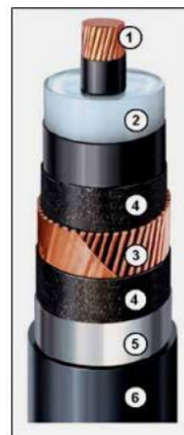
Figur 9. Kabel i genomskärning. 1) ledare, 2) isolation, 3) koppartråd, 4) svällband, 5) aluminiumfolie, 6) polyeten.
