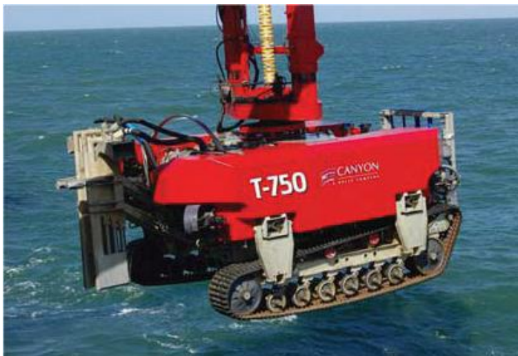
Figur 21. Exempel på utrustning som kan användas vid nedspolning av sjökablar.
