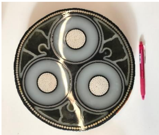
Figur 17. Trefas sjökabel i genomskärning.
