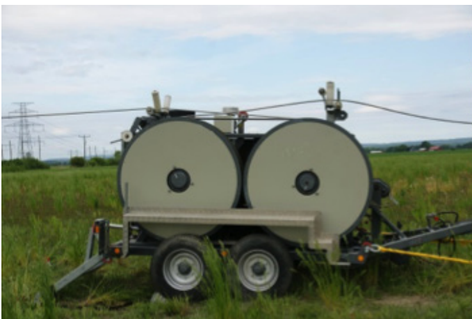
Figur 5.4 Exempel på en drag-/bromsmaskin som används när ledarna ska dras ut mellan stolparna.
