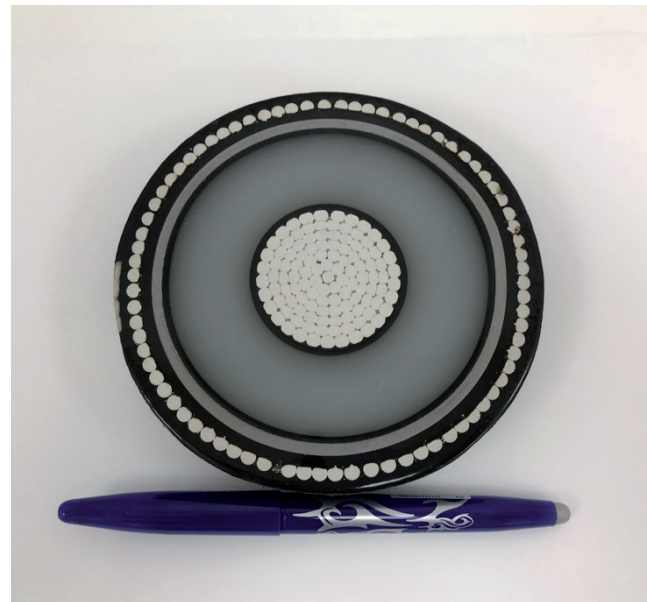
Figur 4.14 Exempel på sjökabel i genomskärning. Under syns en penna för storleksjämförelse. För Hansa PowerBridge kommer koppar- eller aluminiumledare att nyttjas.
