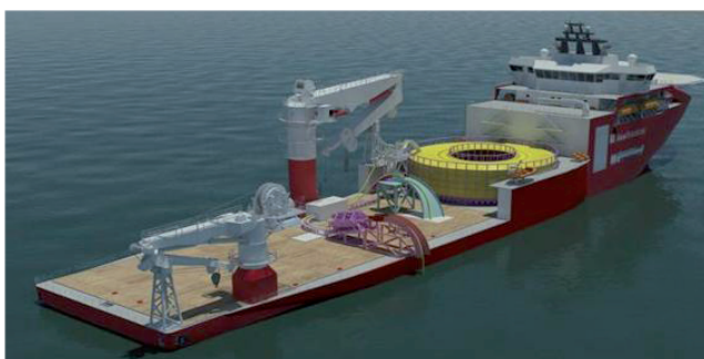
Figur 4.15 Exempel på kabelförläggingsfartyg.
