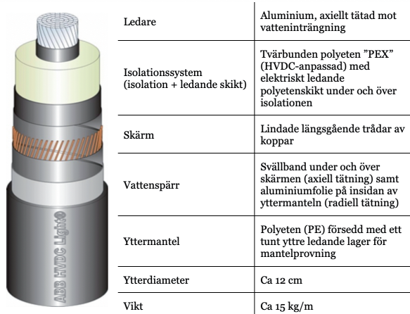
Figur 4.2. Principiell konstruktion av en plastisolerad kabel av enledartyp.
