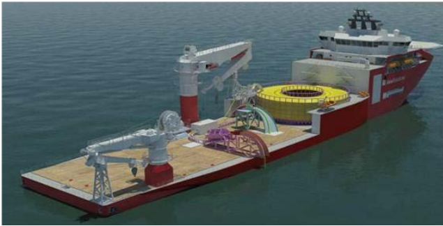
Figur 5.9 Exempel på kabelförleggningsfartyg.
