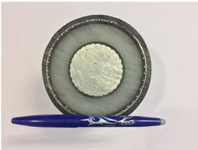
5.3 Exempel på markkabel i genomskärning. I förgrunden syns en penna för storleksjämförelse.
