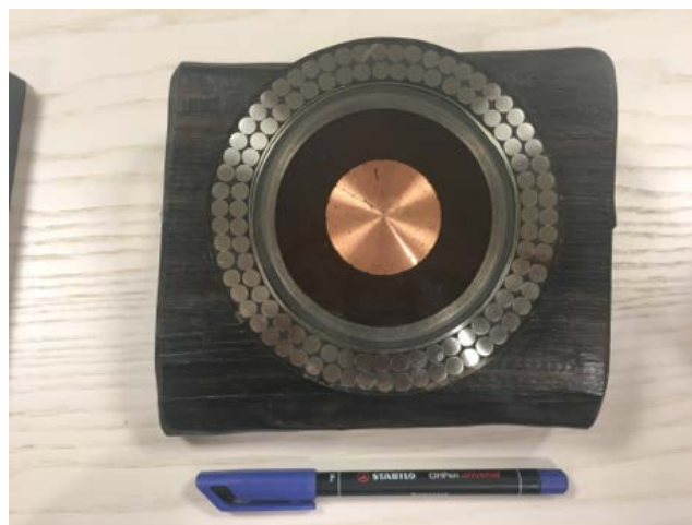
5.8 Exempel på sjøkabel i genomskärning, genomskärningen är på bilden fastsatt på en träbit. Under syns en penna för storleksjämförelse. För Hansa PowerBridge kommer koppar- eller aluminiumledare att nyttjas.
