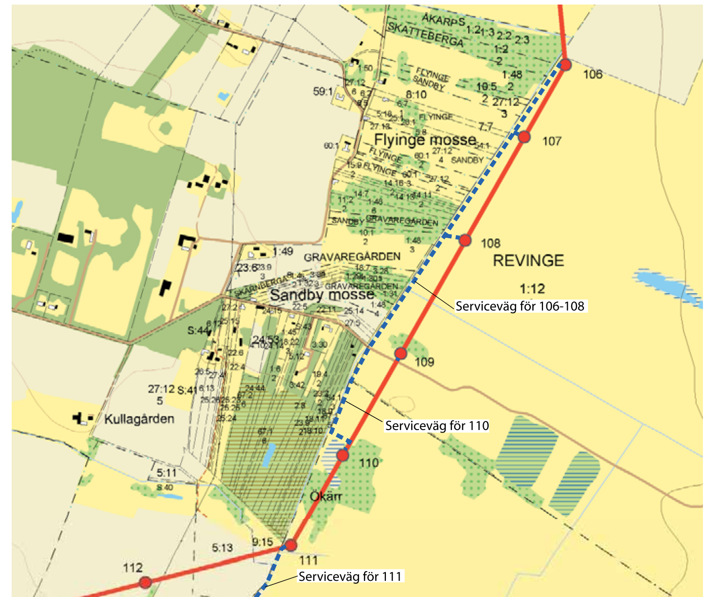
Plan över service/bygg-vägar, utsnitt vid Sandby mosse och Revingefältet.
