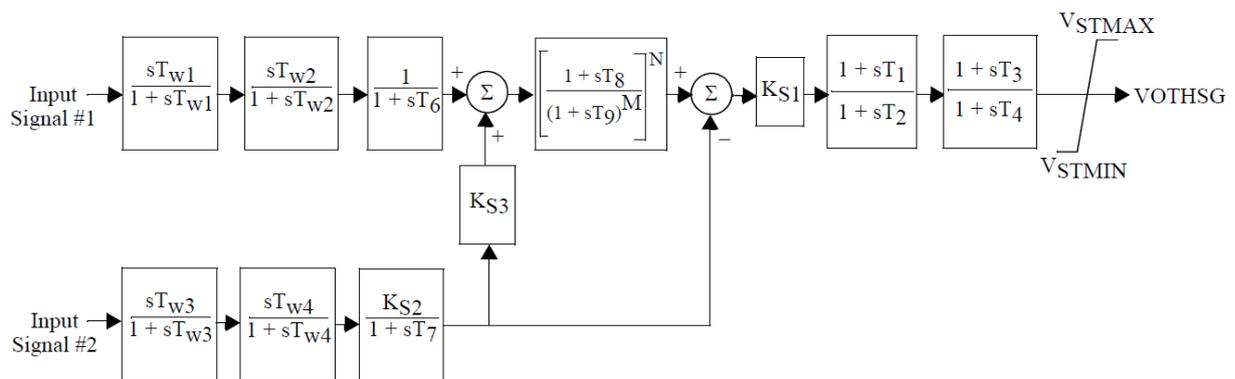
**FIGURE 57: COMMONLY USED POWER SYSTEM STABILISER (PSS) MODEL PSS2A IN THE NORDIC PSS/E SIMULATION MODEL [PSS/E 33.9 MODEL LIBRARY].**
