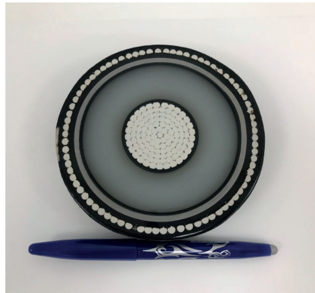
Figur 2.19 Exempel på sjökabel i genomskärning. Under syns en penna för storleksjämförelse. För Hansa PowerBridge kommer koppar- eller aluminiumledare att nyttjas.
