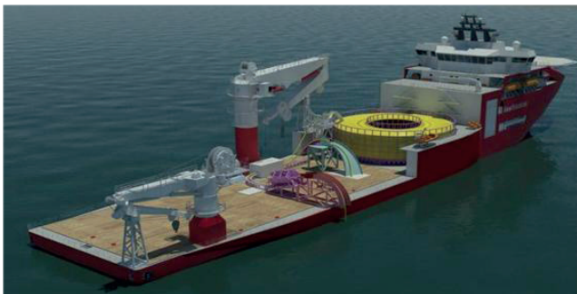
Figur 2.20 Exempel på kabelförläggingsfartyg.
