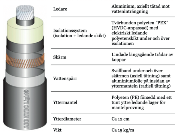
Figur 2.3 Principiell konstruktion av en plastisolerad markkabel av enledartyp.
