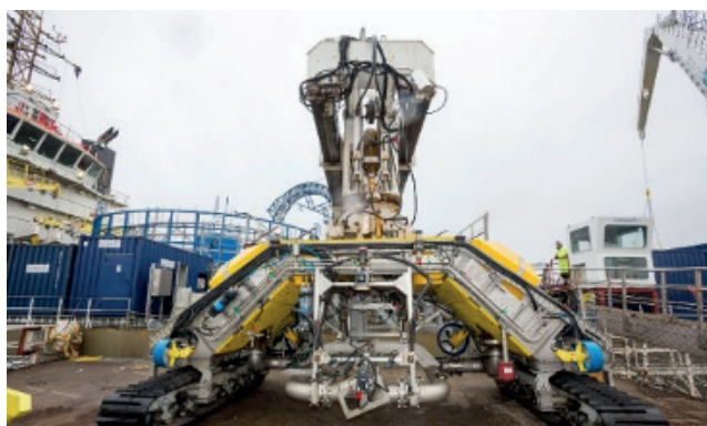
Figur 2.22 Exempel på utrustning som kan användas vid nedspolning.
