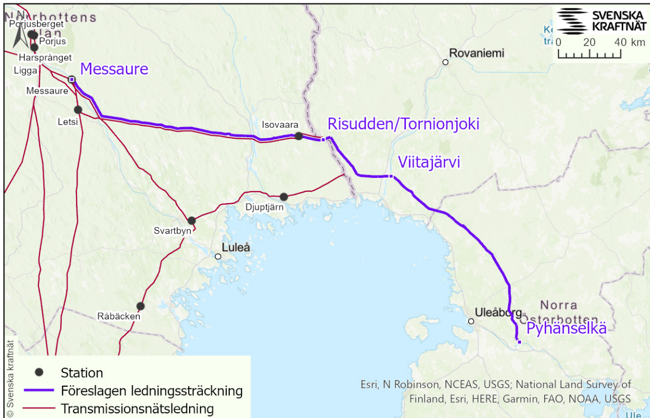
Figur 23. Ny växelströmsledning mellan transmissionsnätsstationerna Messaure och Pyhänselkä.
