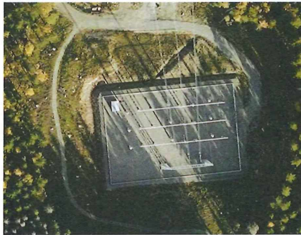
Figur 2 Kabelavslut för 400 kV växelströmsledningen Fjätören – Anneberg terminalplats Fjätören. Dimensionerna är ca 67 x 45 m 2 (från Eniro Kartor). Tomtarean uppgår till knappt 13 000 m 2 .
