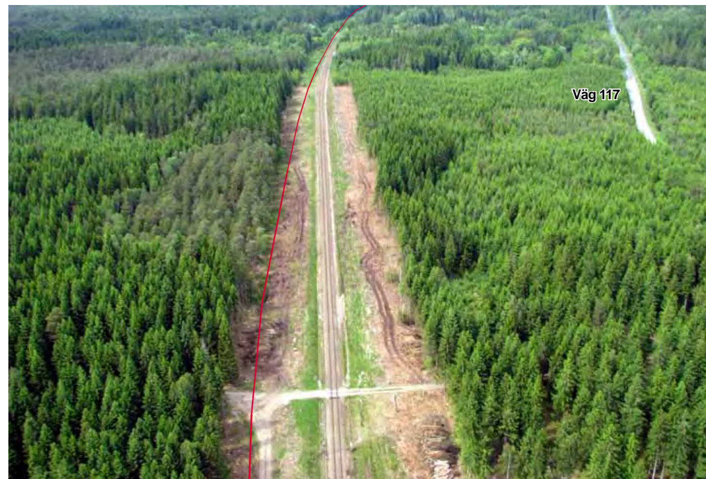
Figur 12.12 Vy mot norr längs järnvägen Markaryd–Hässleholm, på avsnittet mellan Södra Århult och Emmaljunga. Landskapet längs järnvägen domineras av barrskog och mossmark. Längs stora delar av sträckan finns träsäkra gator längs banvallen och parallella körvägar.
