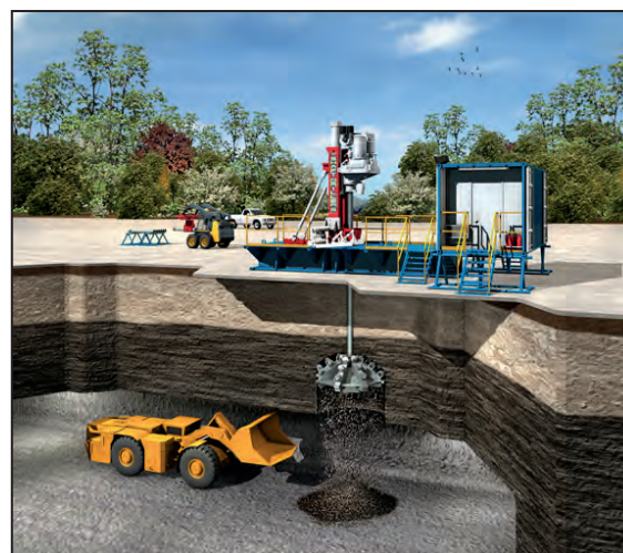
Figur 5.4. Illustration av schaktbörningsmaskin, s.k. raiseborrning (Svenska kraftnät, 2015).
