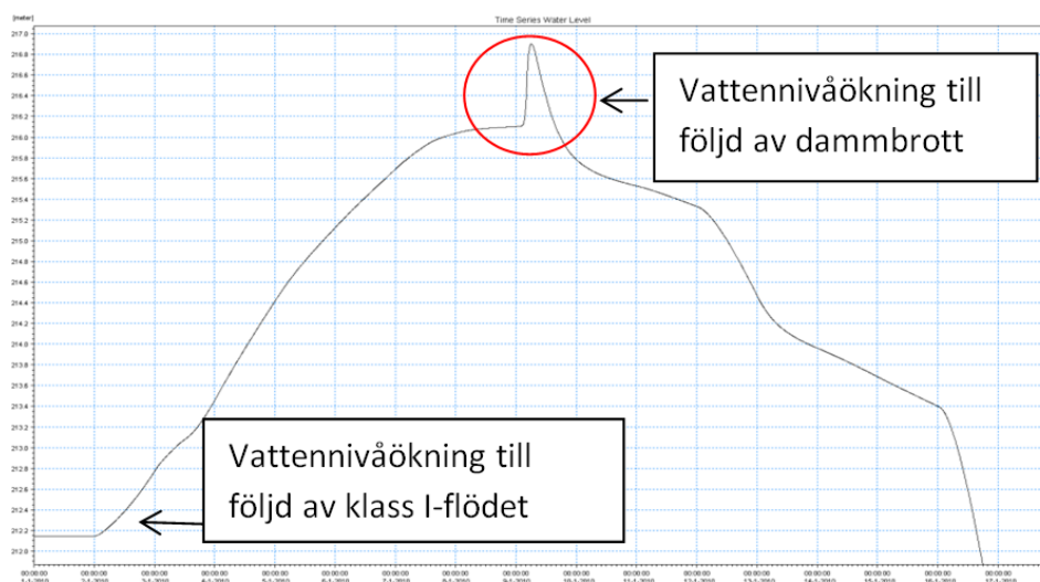
Figur 20. Vattennivåökning till följd av ett dammhaveri vid klass I-flöde. I grafen återfinns vattennivån på y-axeln och tiden på x-axeln.
