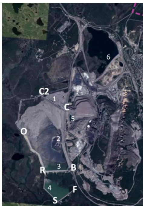
Figur 3.2. LKAB:s dammar i Kiruna kan indelas i två dammanläggningar;
