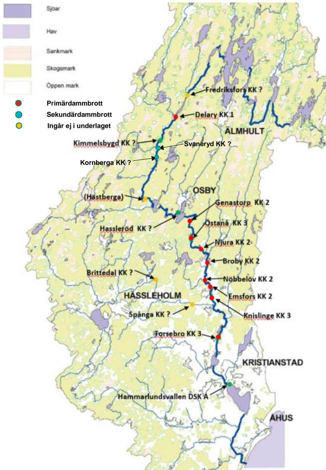
Figur 2-1: Översikt över dammanläggningar i Helge å. Beredskapsunderlaget omfattar dammarna i Helge å huvudfåra – markerad med tjock blå linje – och samtliga dammar i denna från Delary ned till mynningen.
